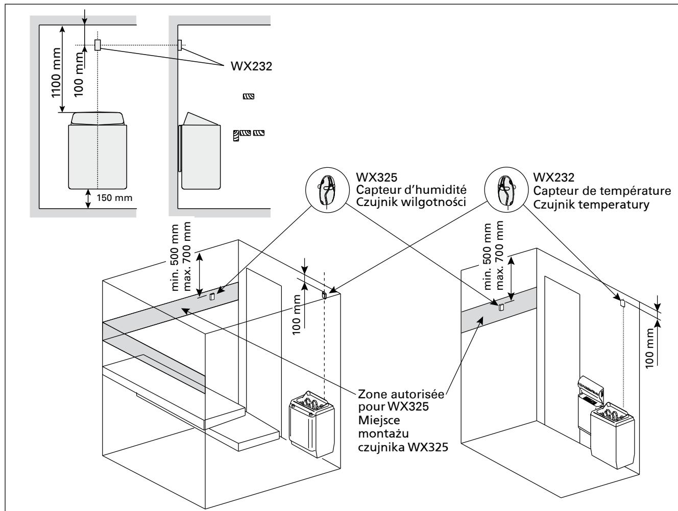
*Figure 8. Emplacement des capteurs de température et d'humidité par rapport aux poêles en installation murale
