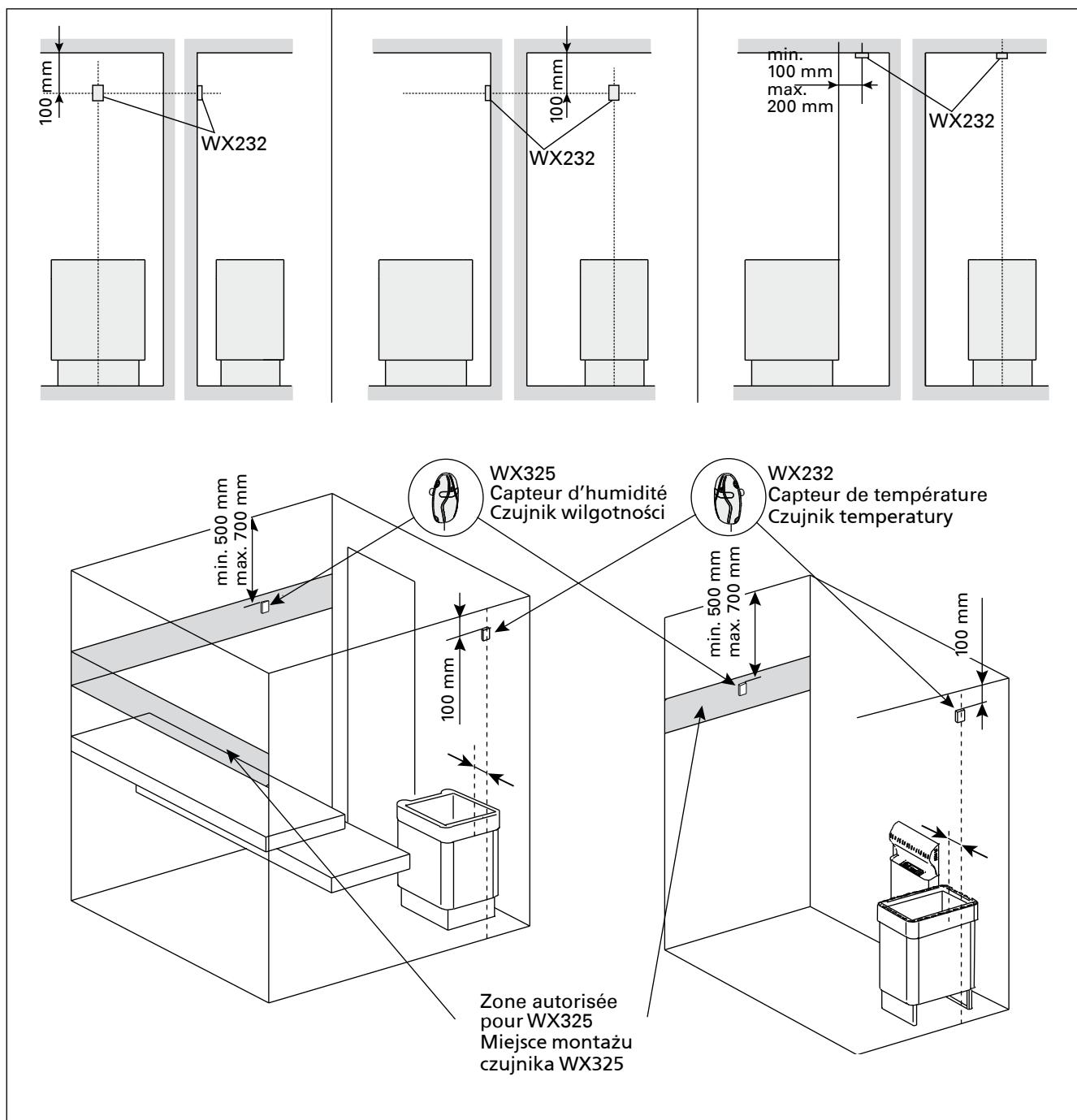
Figure 9. Emplacement des capteurs de température et d'humidité par rapport aux poêles en installation au sol
