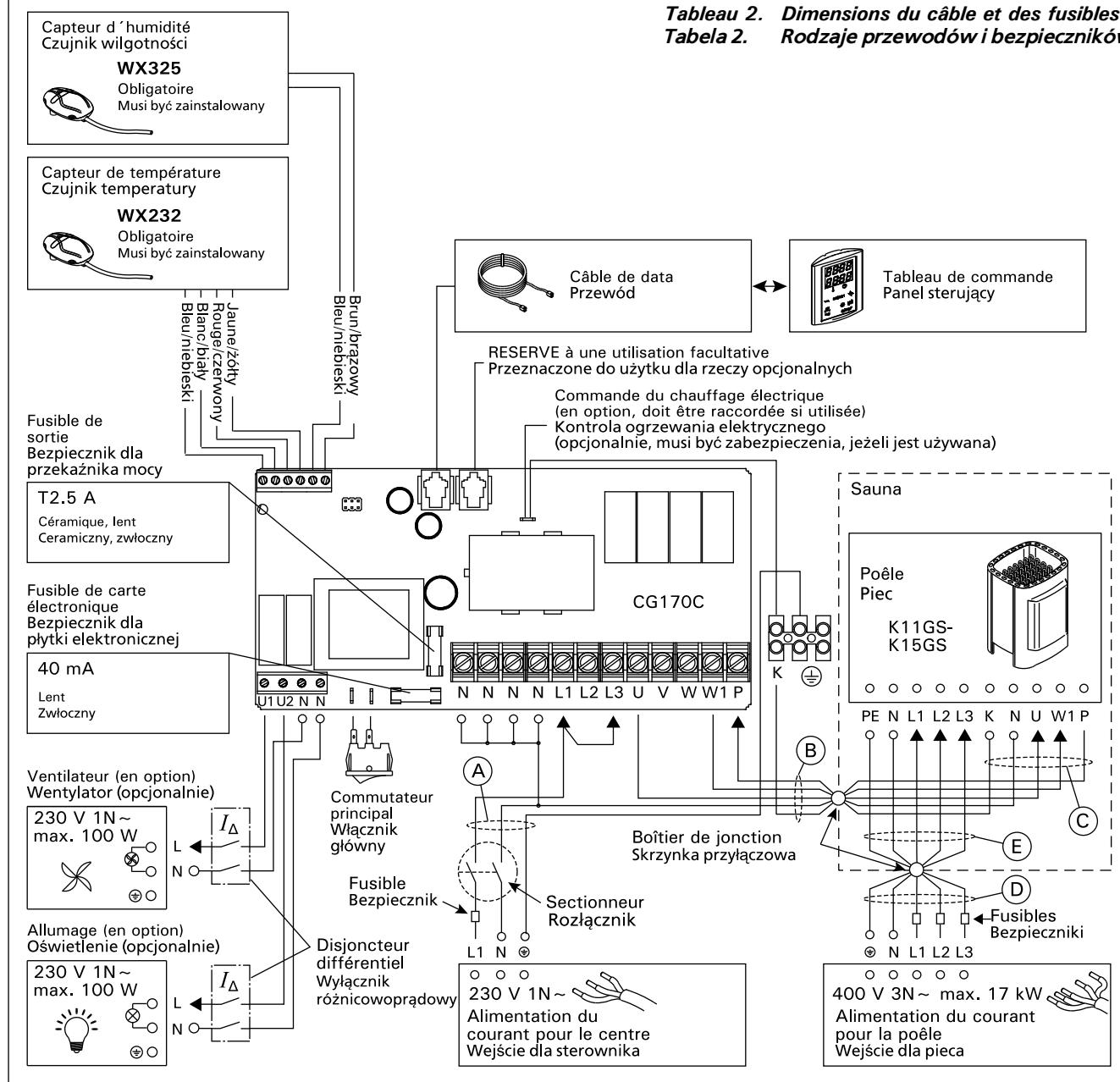
Figure 6. Raccordement électrique (K11GS-K15GS)
