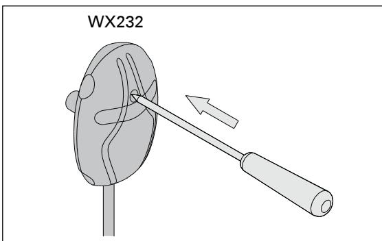
**Figure 11.** Bouton de réinitialisation de la sécurité surchauffe
