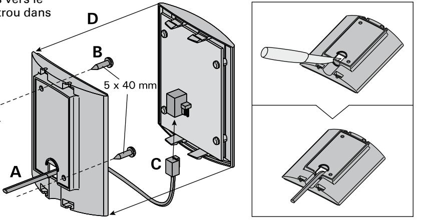
*Figure 4. Fixation du tableau de commande*
