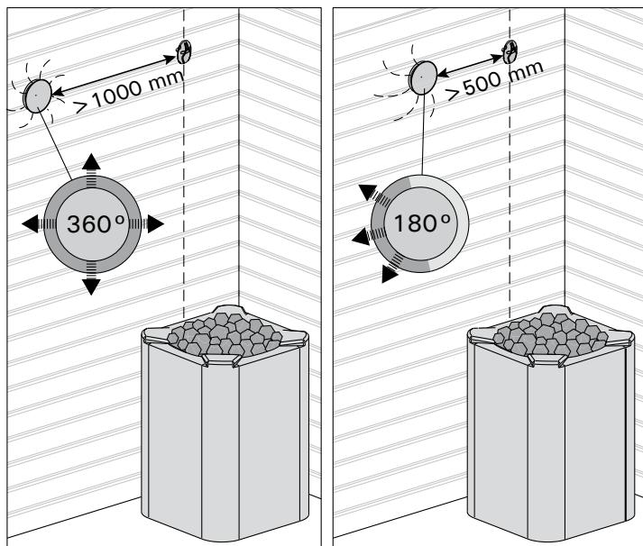
**Figure 10.** Distances minimales du capteur avec le tuyau d'air
