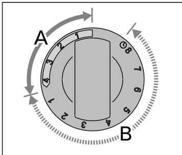
**Kuva 2. Kellokytkimen säädin**
