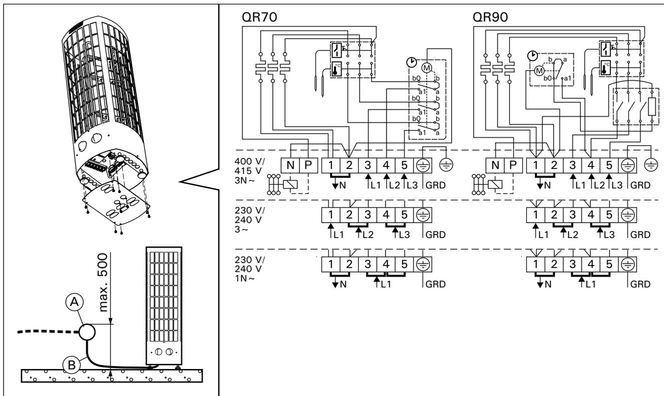
Kuva 7. Sähkökytkennät
