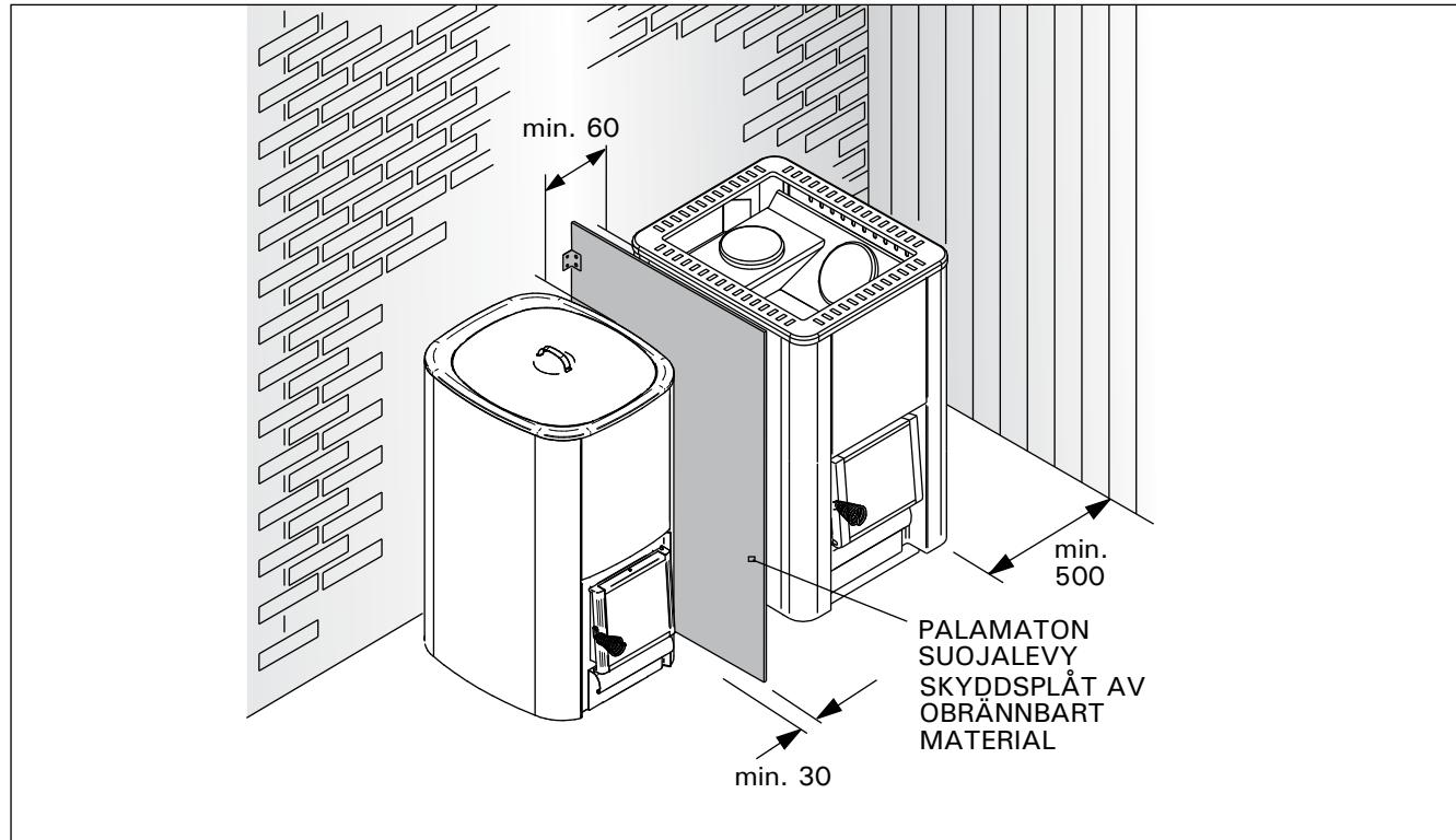
Kuva 6. Pata ja puulämmittelineen kiuas rinnakkain (mitat millimetreinä)
