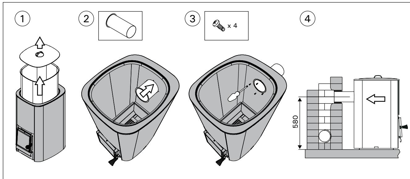
Kuva 7. Padan liittäminen muurattuun savuhormiin (mitat millimetreinä)
