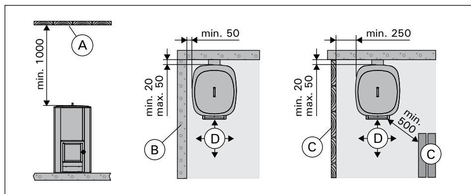
**Kuva 5. Suojaetäisydet (mitat millimetreinä)**
