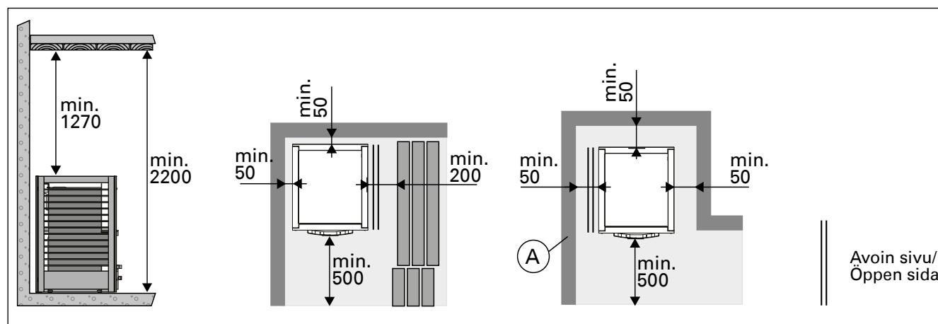
Kuva 9. Suojaetäisyydet (mitat millimetreinä)
