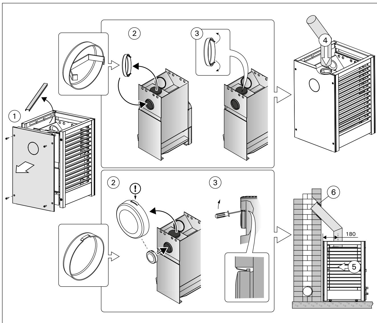
**Kuva 14. Kiukaan liittäminen muurattuun savuhormiin yläliitäntääukon kautta (mitat millimetreinä)**
