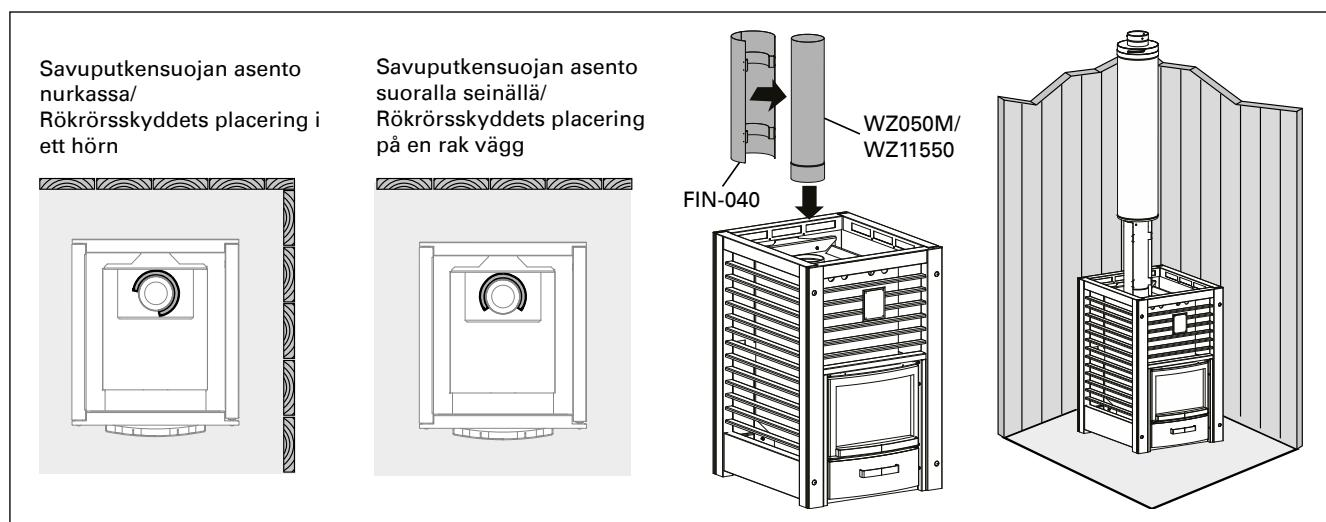
Kuva 10. Suojaustarvikkeet (mitat millimetreinä)
