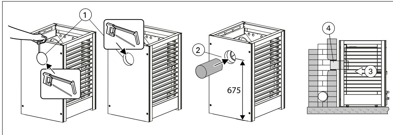
**Kuva 13. Kiukaan liittäminen muurattuun savuhormiin takaliitäntääukon kautta (mitat millimetreinä)**
