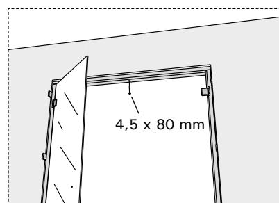
G. Prova att dörren öppnas och stängs väl. Ändra vid behov karmens läge med hjlp av kilar. Kom ihåg att öppna skruven något bredvid kilen först. Till sist sätt fast övre karmstycke med skruvar. Glöm inte kilarna.
