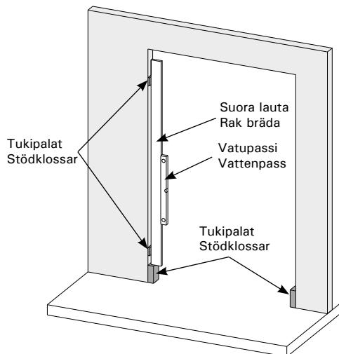
C. Montera stödklossar till öppningens sidor. Kom ihåg att lämna justeringsreserv på båda sidorna av öppningen. Montera stödklossarna noggrant i vertikal riktning. En rak bräda kan användas som förlängning om vattenpasset är för kort. Lägg lämpliga stödklossar på golvet under karmändan.
