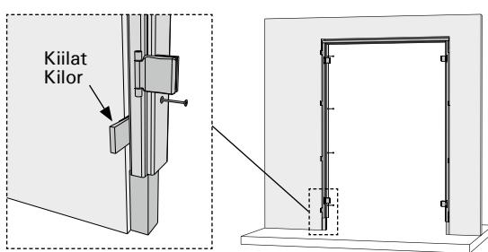
E. Skruva fast ena karmsidan till vägg, börja med översta skruven. Sätt kilarna mellan stödklossarna bredvid skruvhålen.
