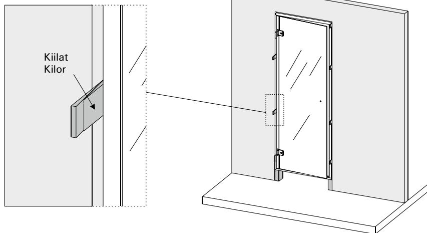
F. Kun karmit on kiinnitetty ruuveilla, tarkista vielä että karmit ovat suorassa ja ovi käy hyvin. Tiivistää oven ja seinän väli. Mikäli seinän materiaali on huokoinen, esim. kahitiili tai siporex-harkko, varmista oikea kiinnitys- ja tiivistystapa kauppiaaltasi. Sahaa tarvittaessa kiilat karmiin yliittäväältä osalta (saha pystyasennossa). Poista alatuet ja karmien tukirima. Asenna lopuksi listat ja kahva.
