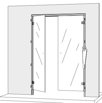
I. När karmen är fäst med skruvar, kontrollera än en gång att ramen är rak dörren öppnas och stängs ordentligt. Täta springan mellan dörr och vägg. Korta av kilen vid behov (såg i vertikal riktning). Ta bort stödklossarna under dörren.
