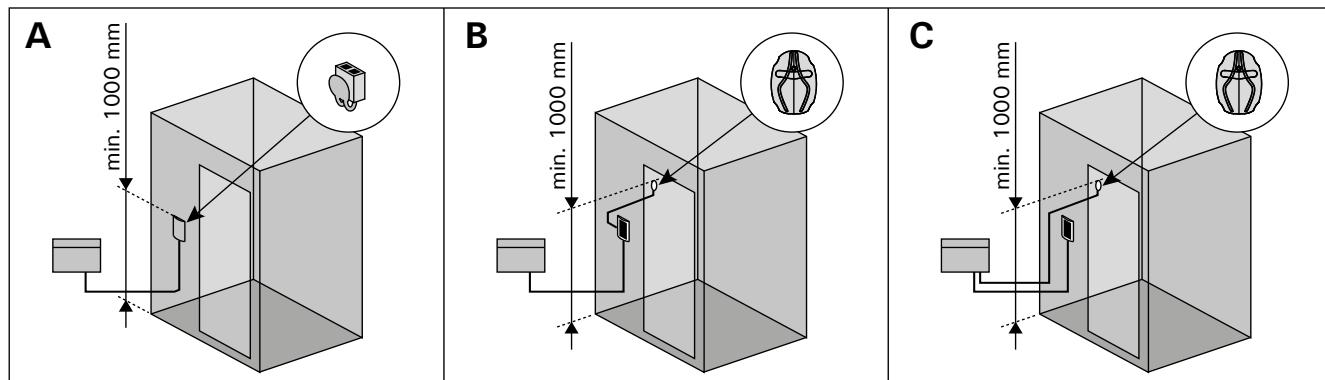
Obr. 4. Možnosti pro typy čidel a jejich umístění
