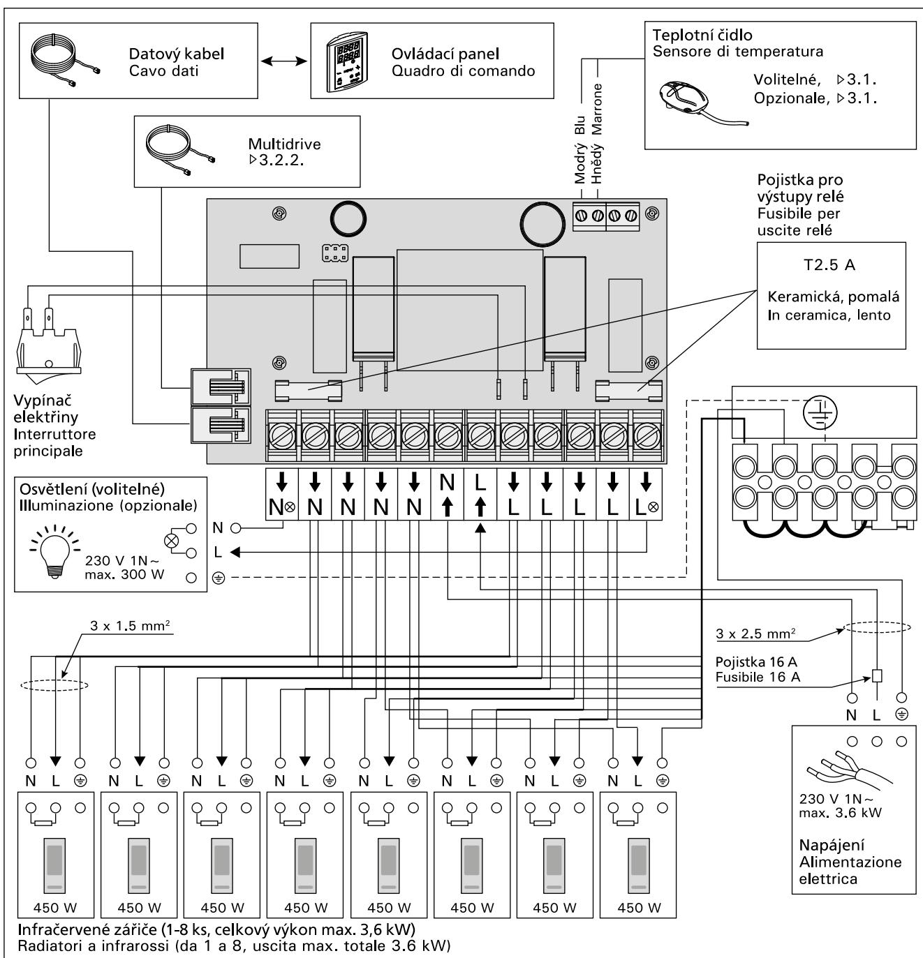
Obr. 7. Elektrické připojení
