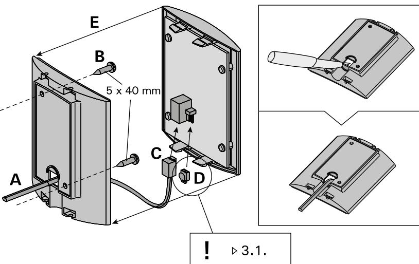
Obr. 9. Upevnění ovládacího panelu
