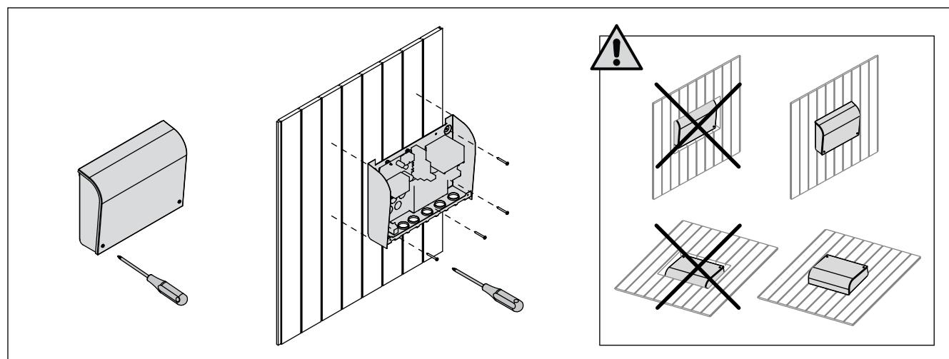
Obr. 6. Otevření krytu napájecí jednotky a její montáž
