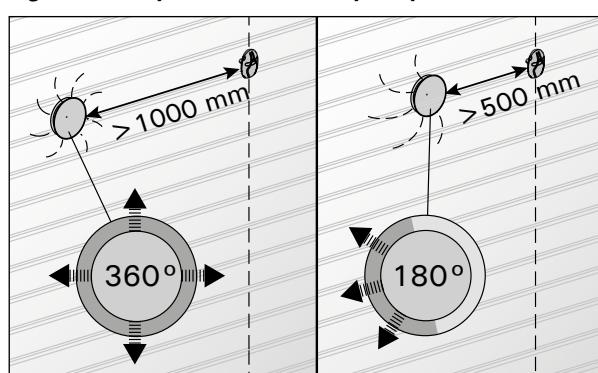
Obr. 5. Minimální vzdálenost čidla od ventilačního otvoru
