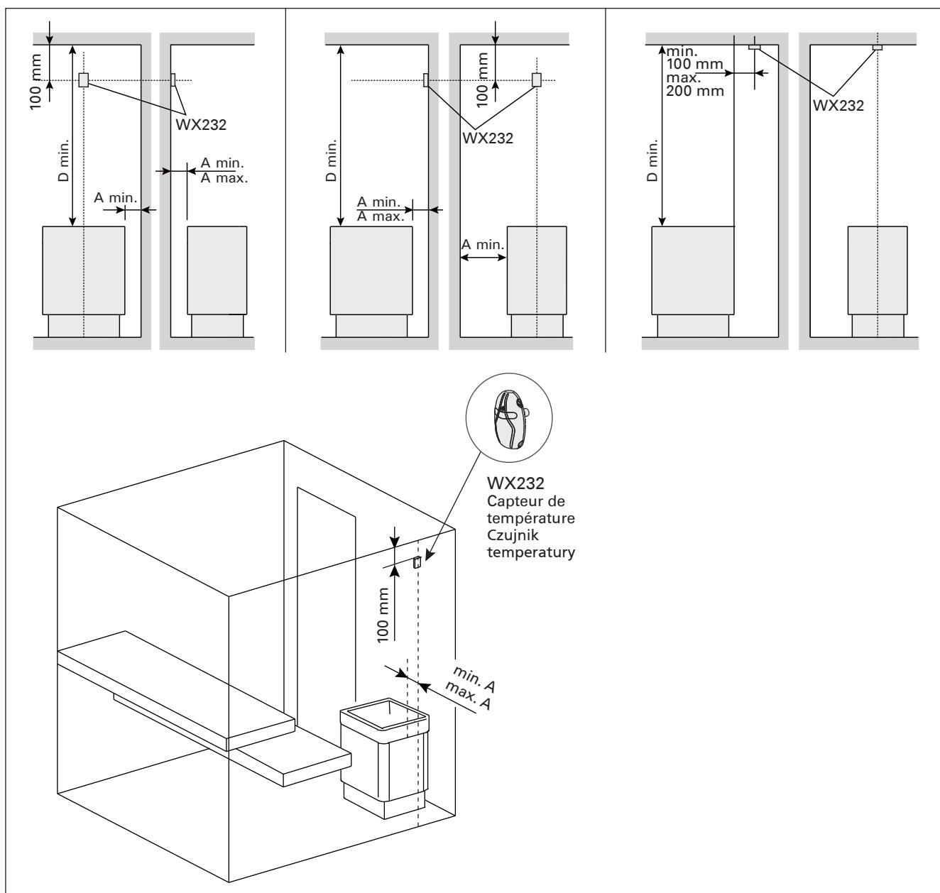
*Figure 6. Emplacement du capteur de température par rapport aux poêles en installation au sol*
