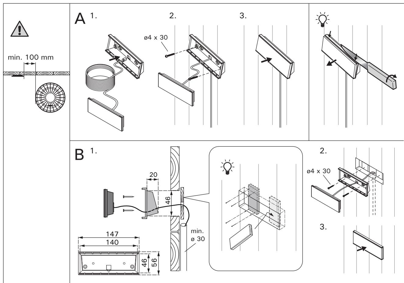
Figure 2. Fixation du tableau de commande
