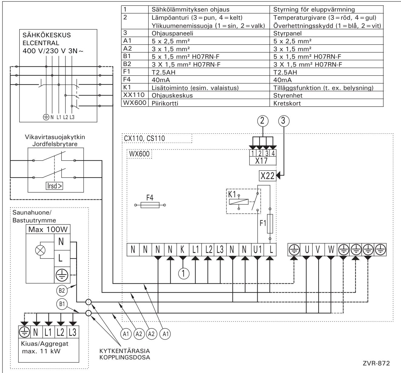
**Kuva 4. Sähkökytkennät**
