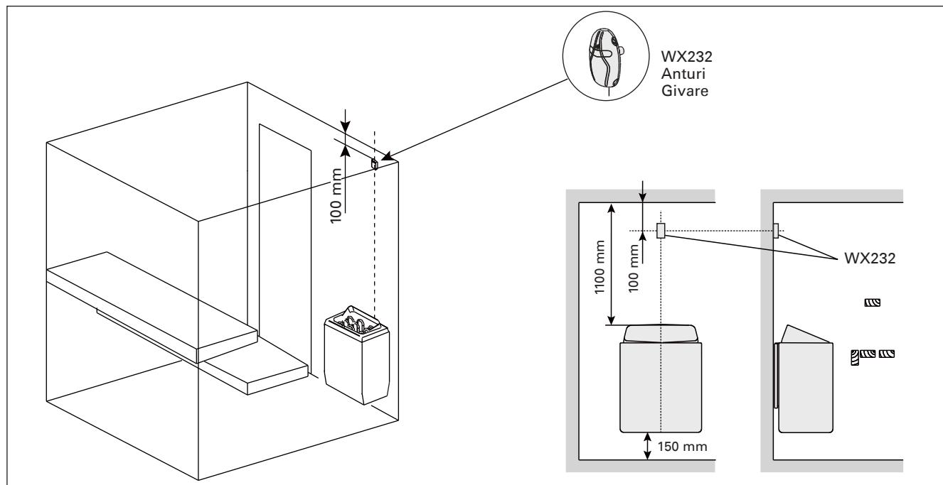
Kuva 5. Lämpöanturin sijainti seinään kiinnitettävien kiukaiden yhteydessä
