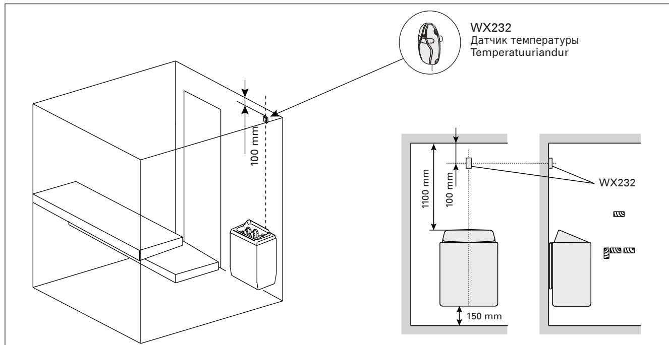
Рисунок 5. Расположение датчиков температуры относительно настенных нагревателей
