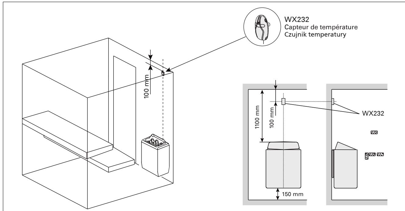
Figure 5. Emplacement du capteur de température par rapport aux poêles en installation murale
