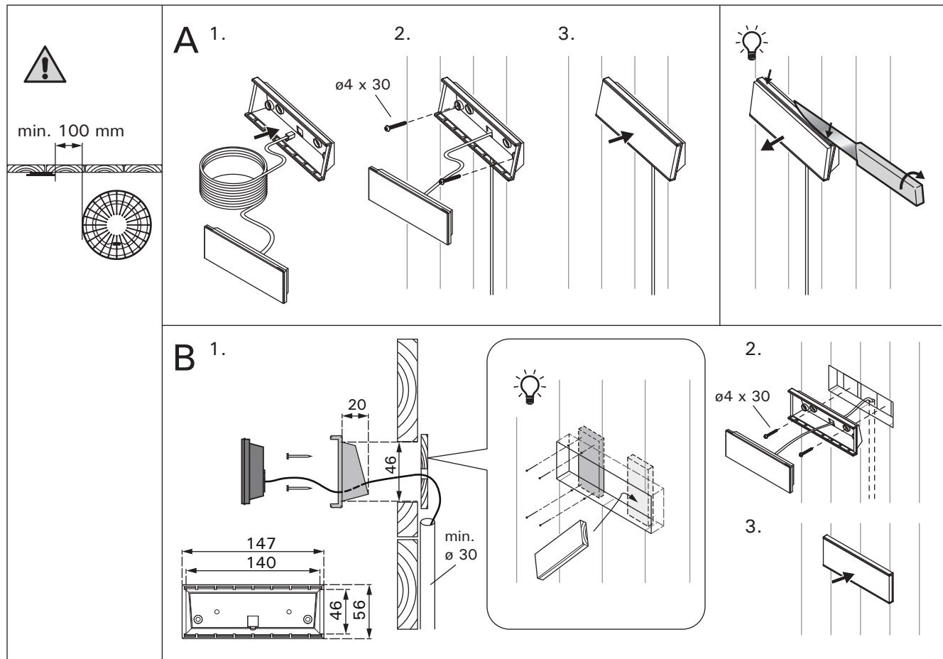
**Рисунок 2. Установка панели управления
