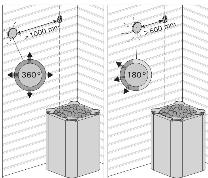
*Figure 7. Distance minimale du capteur avec le conduit d'air*
