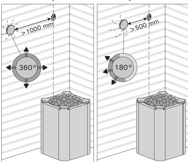
**Рисунок 7. Минимальное расстояние между датчиком и вентилятором**
