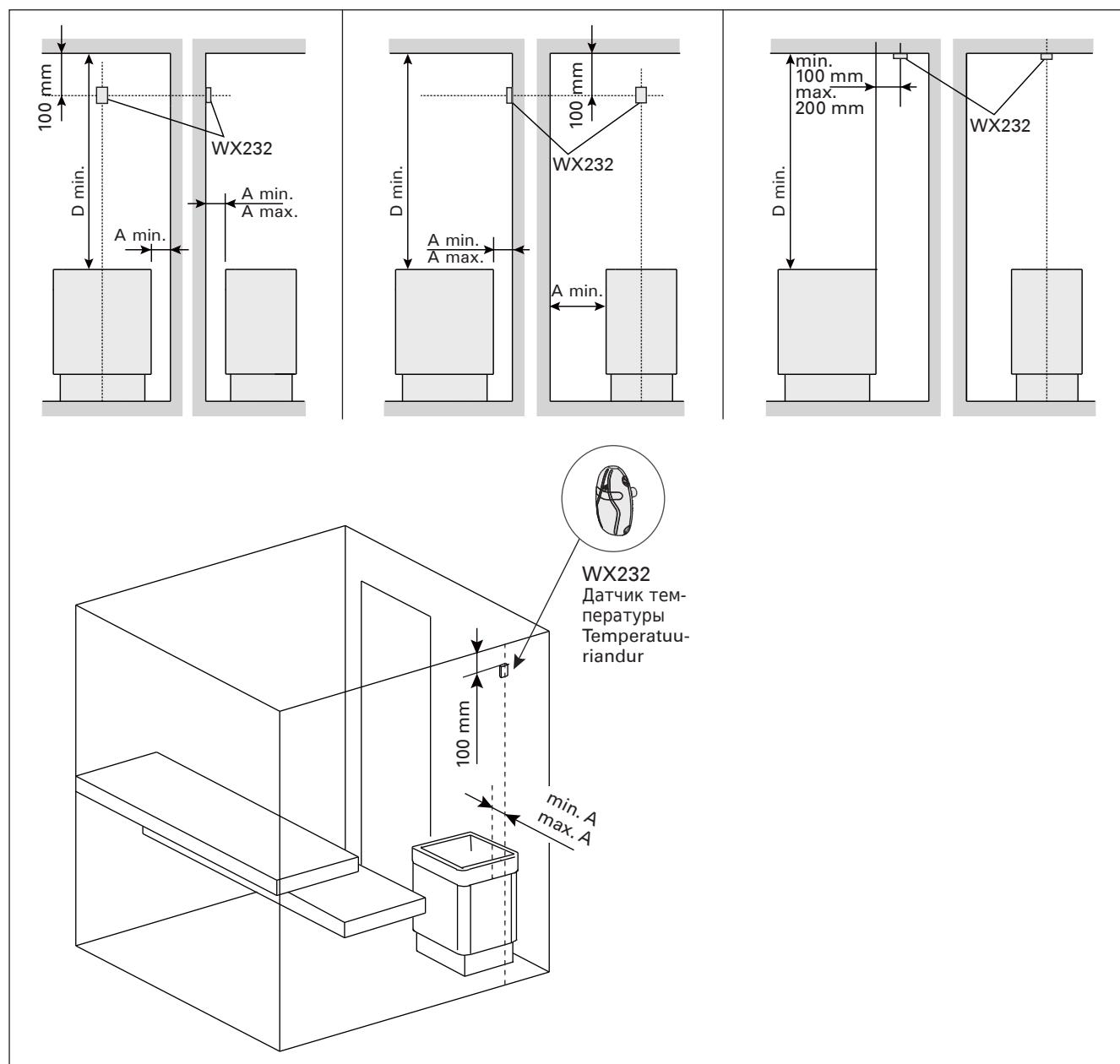
**Рисунок 6. Расположение датчиков температуры относительно напольных нагревателей**
