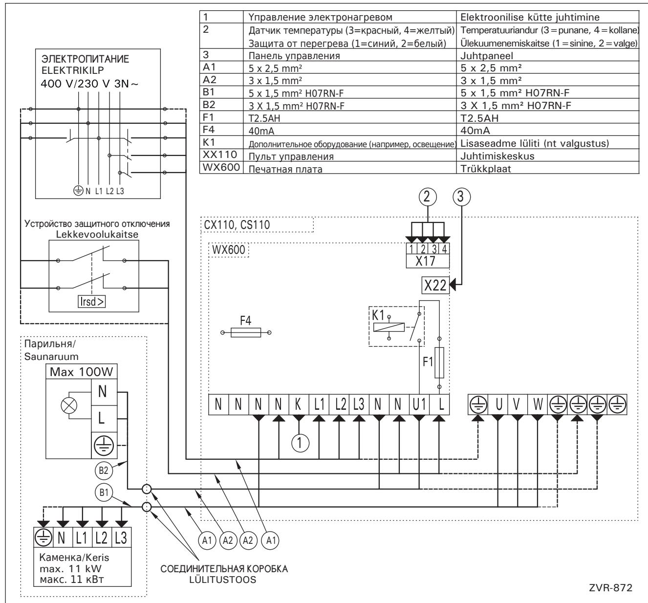
**Рисунок 4. Электрические подключения**
