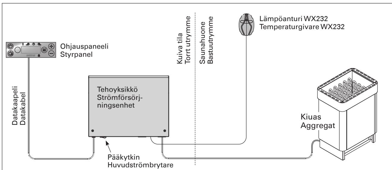
**Kuva 1. Järjestelmän osat**
