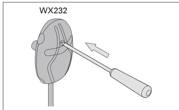
Figure 8. Bouton de réinitialisation de la sécurité-surchauffe
