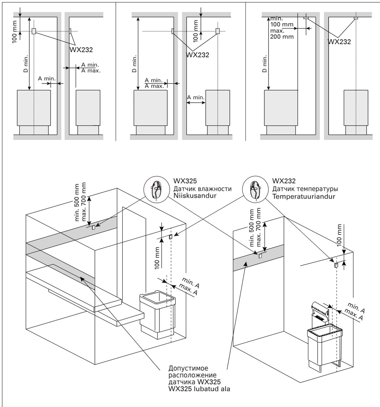
Рисунок 7. Расположение датчиков температуры и влажности относительно напольных нагревателей
