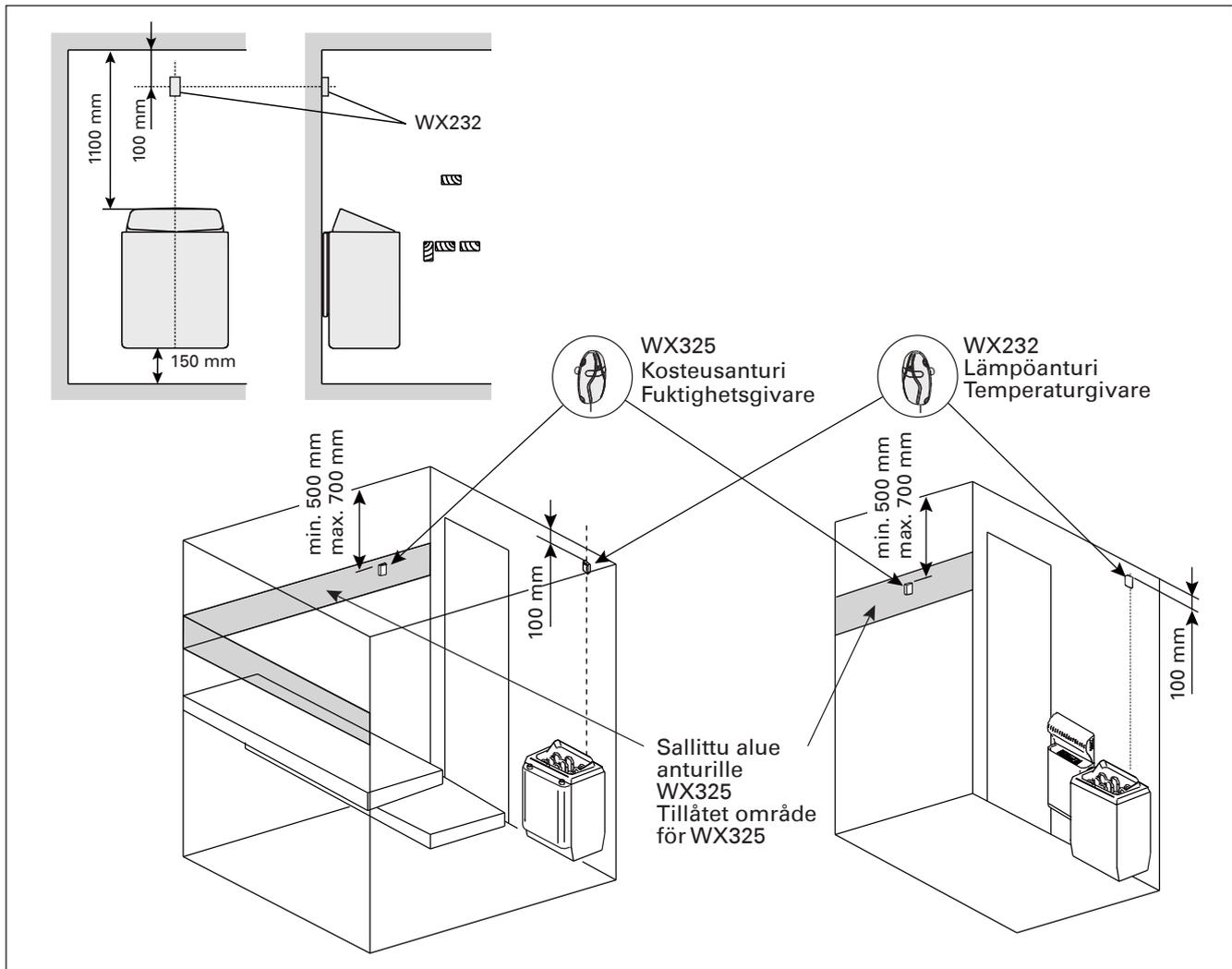
**Kuva 6. Lämpö- ja kosteusantureiden sijainti seinään kiinnitettävien kiukaiden yhteydessä**
