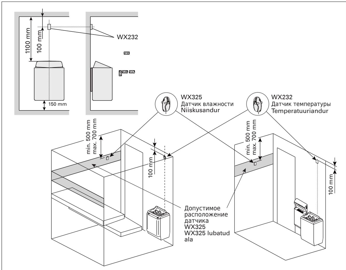
**Рисунок 6. Расположение датчиков температуры и влажности относительно настенных нагревателей**
