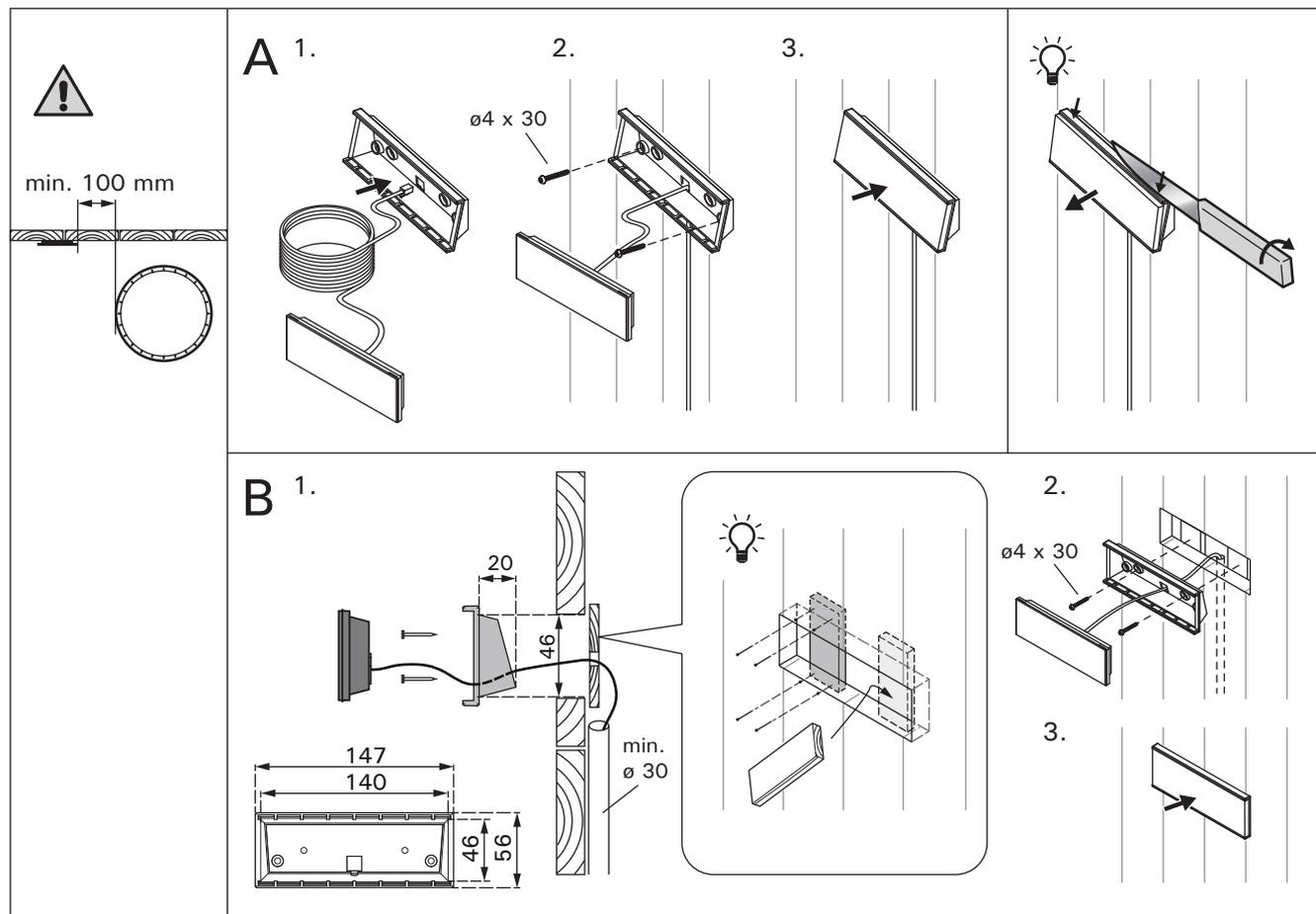
Рисунок 2. Установка панели управления
