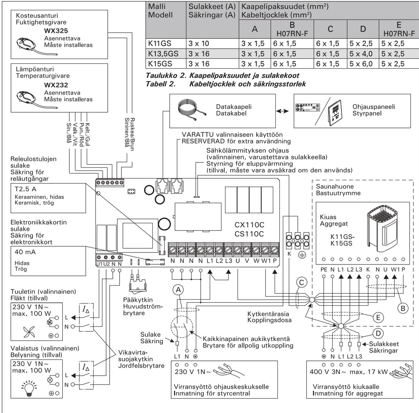
**Kuva 4. Sähkökytkennät (K11GS–K15GS)**
