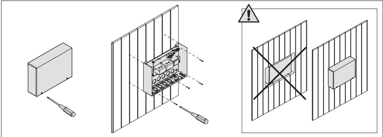
Figura 3. Apertura del coperchio dell'unità di alimentazione e montaggio dell'unità alla parete
