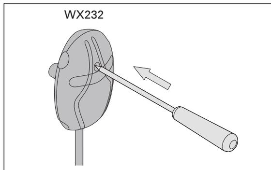
**Рисунок 9. Кнопка сброса защиты от перегрева**
