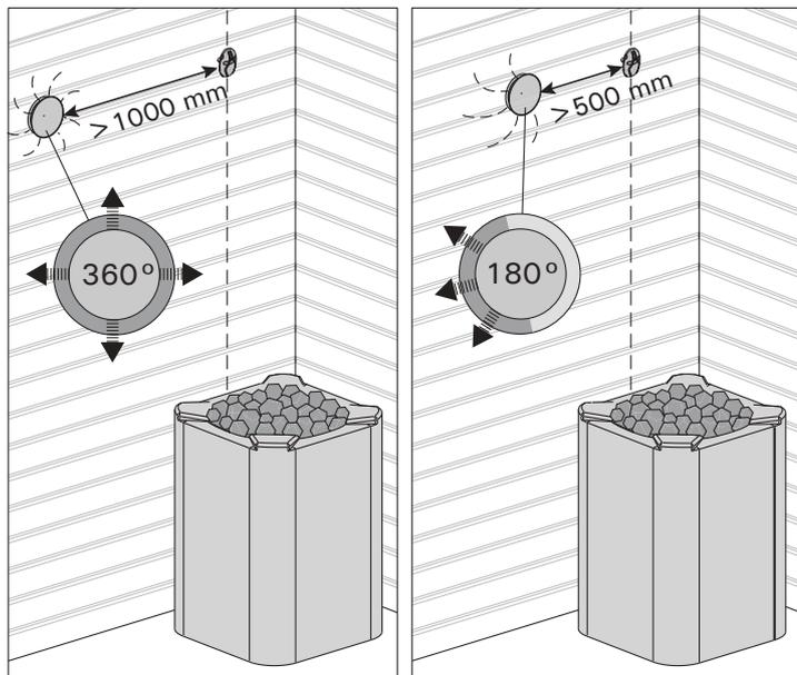
**Рисунок 8. Минимальное расстояние между датчиком и вентилятором**
