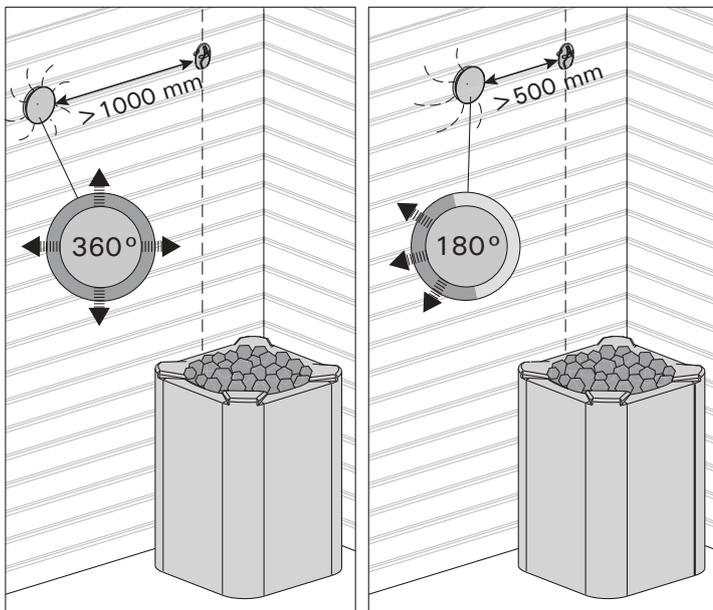
**Figure 8.** Distances minimales du capteur avec le tuyau d'air
