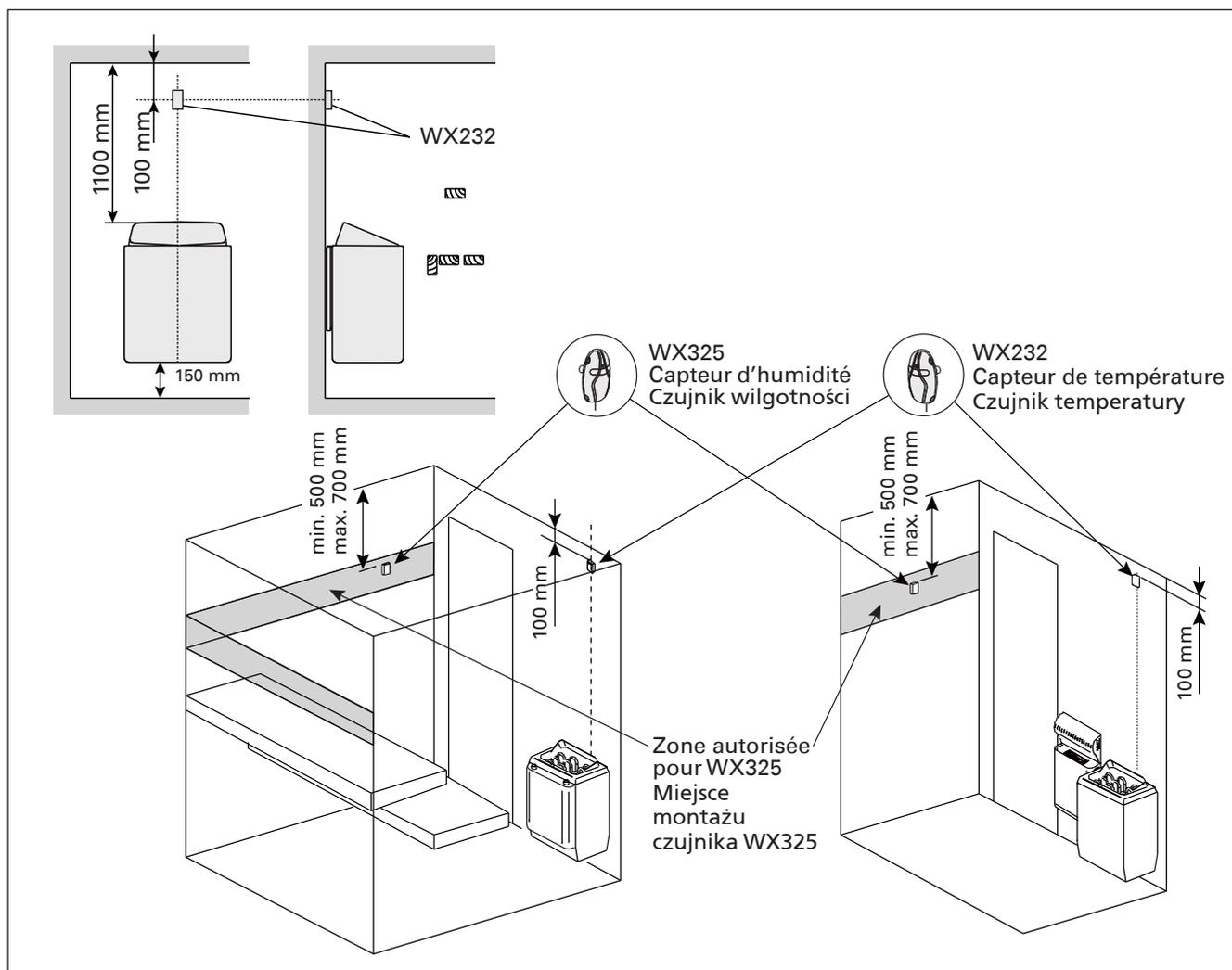
Figure 6. Emplacement des capteurs de température et d'humidité par rapport aux poêles en installation murale
