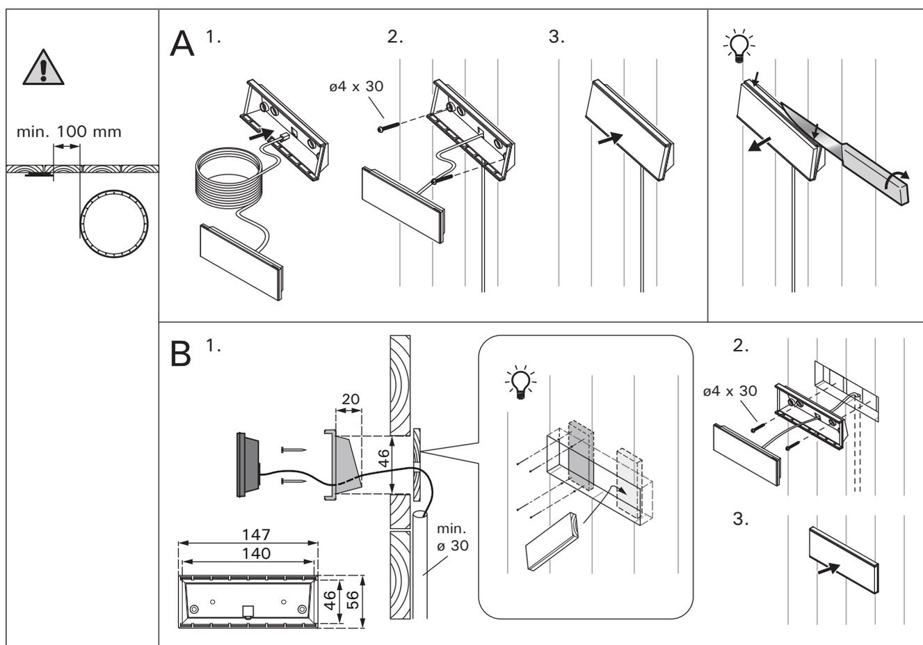
Figure 2. Fixation du tableau de commande
