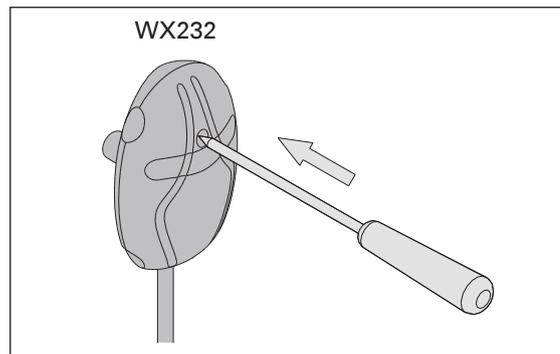
**Figure 9.** Bouton de réinitialisation de la sécurité surchauffe
