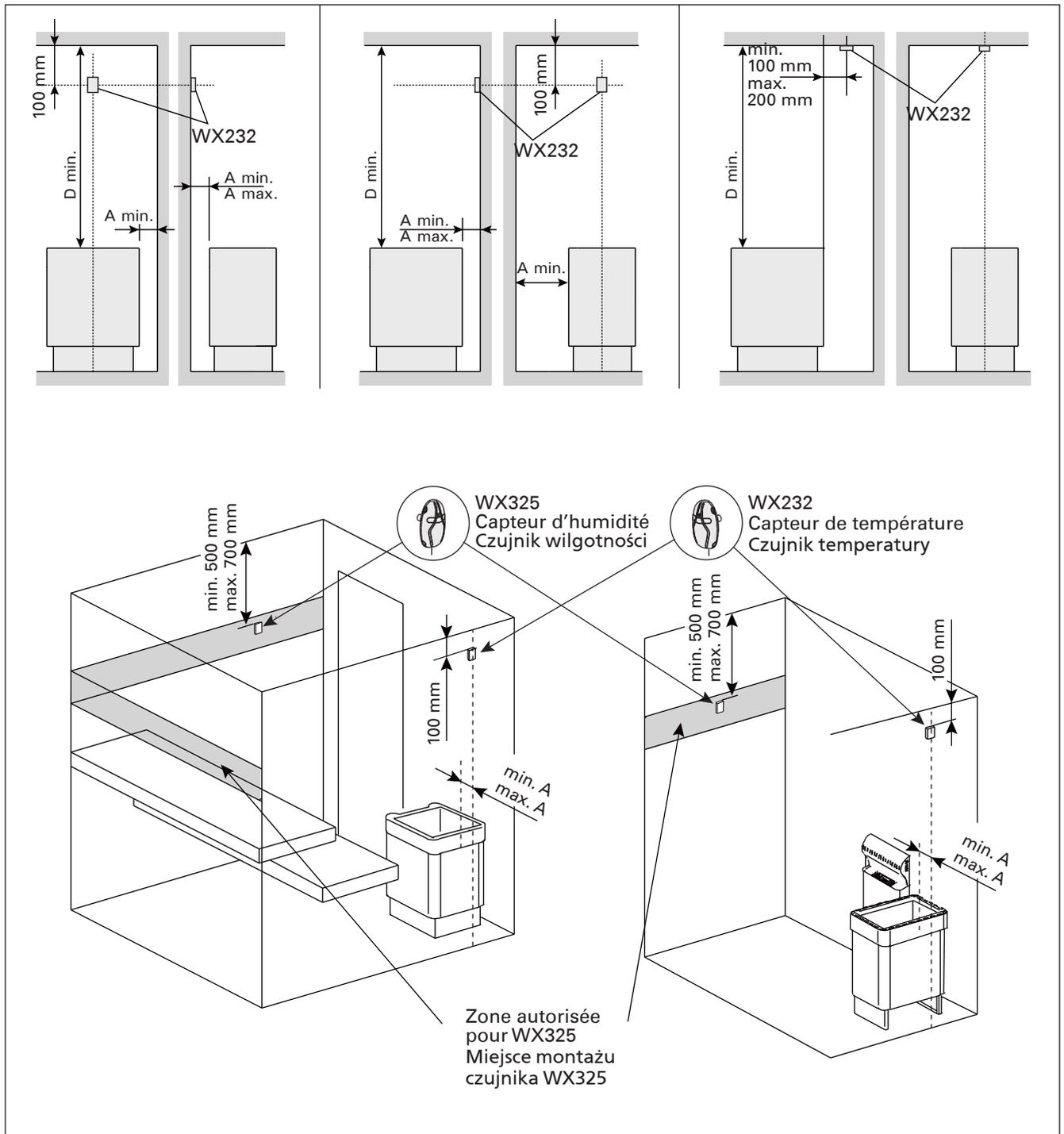
Figure 7. Emplacement des capteurs de température et d'humidité par rapport aux poêles en installation au sol
