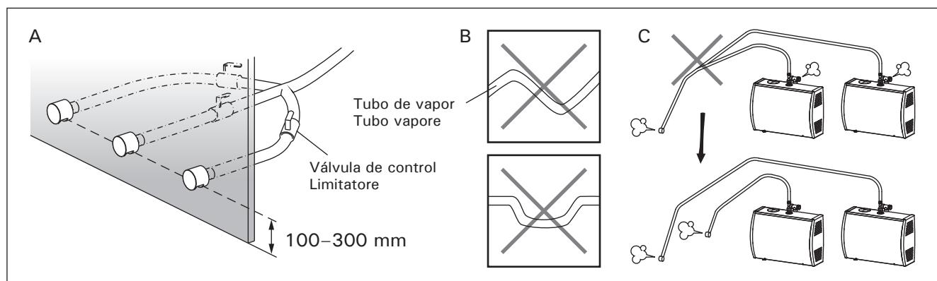
*Figura 11. Boquillas y tubos de vapor*
