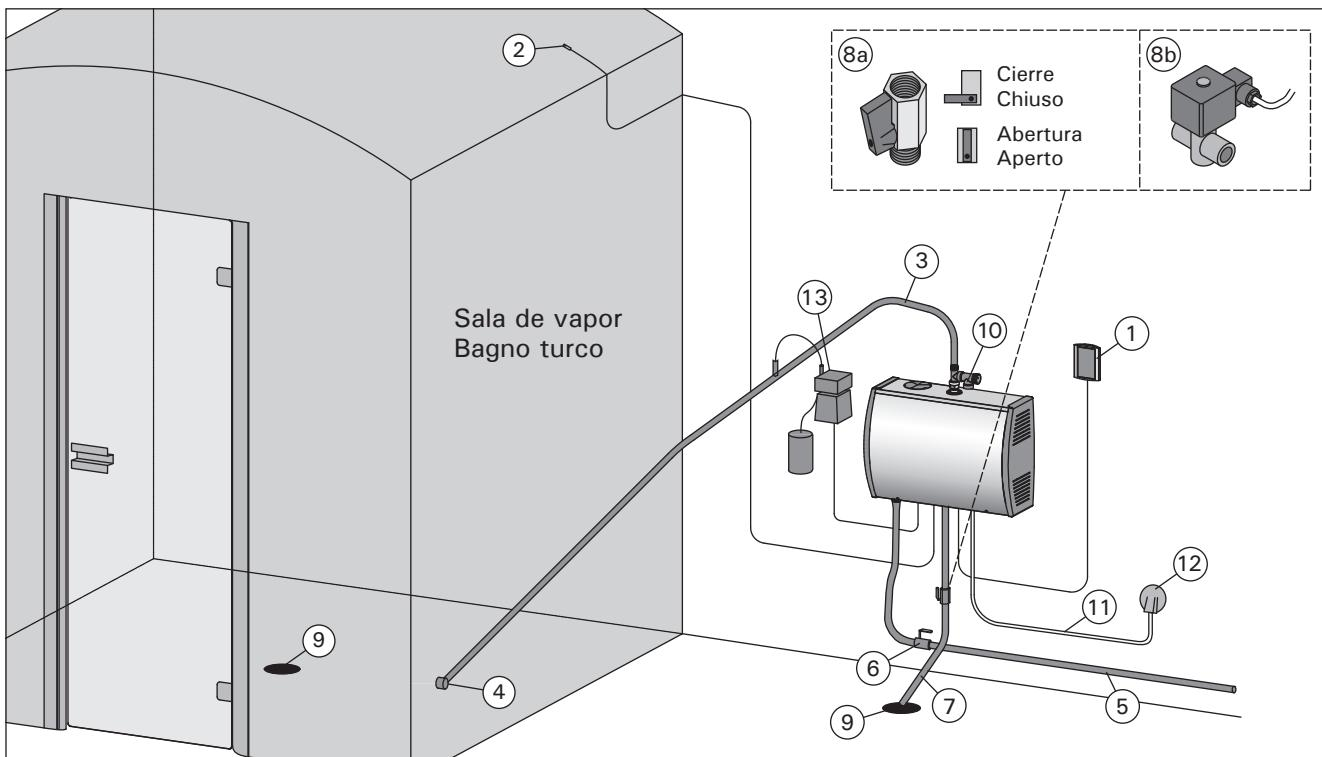
Figura 1. Componentes del sistema generador de vapor
