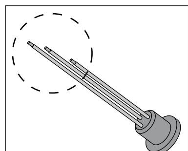
Figura 5. Puntas de los pasadores del sensor de superficie
