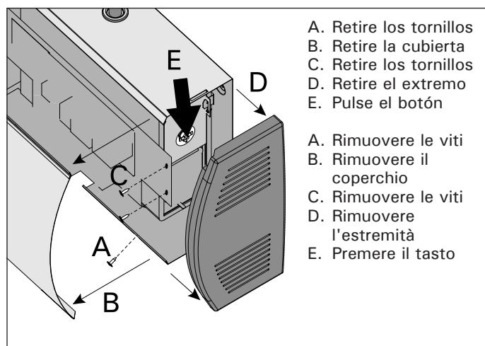
*Figura 13. Cómo volver a programar el protector de sobrecalentamiento*
