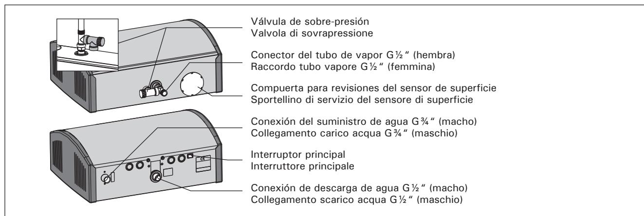
*Figura 10. Conexiones del generador de vapor*
