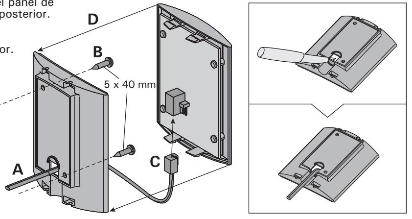
Figura 12. Cómo fijar el panel de control
