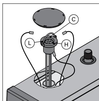
Figura 4. Cómo desacoplar el sensor de superficie
