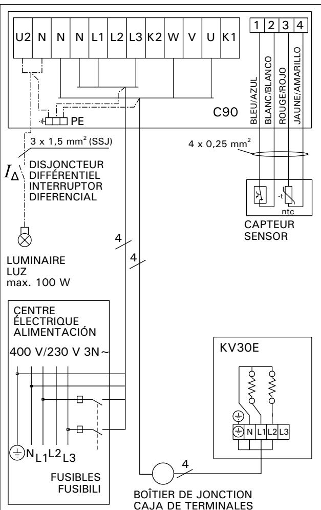
Figure 12a. Raccordement électrique (centre de contrôle C90 + KV30E)
