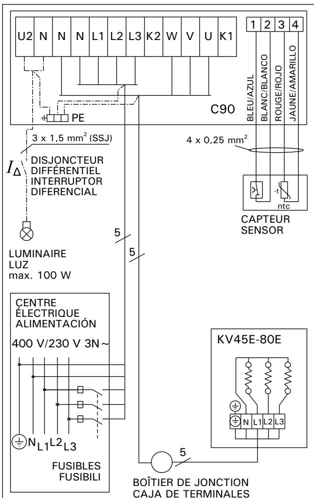
Figure 12b. Raccordement électrique (centre de contrôle C90 + KV45E-80E)
