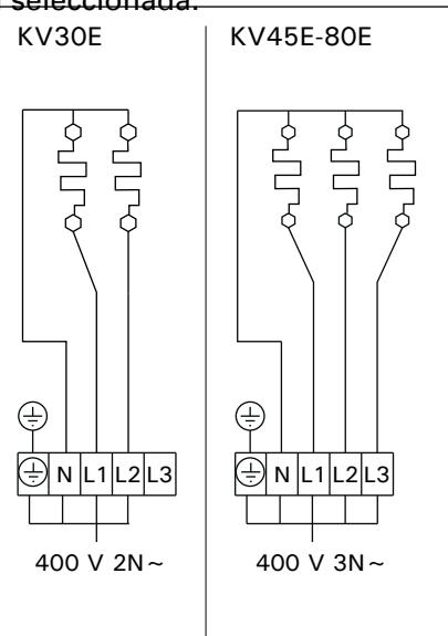
Figure 12. Raccordement électrique (KV30E-80E)
