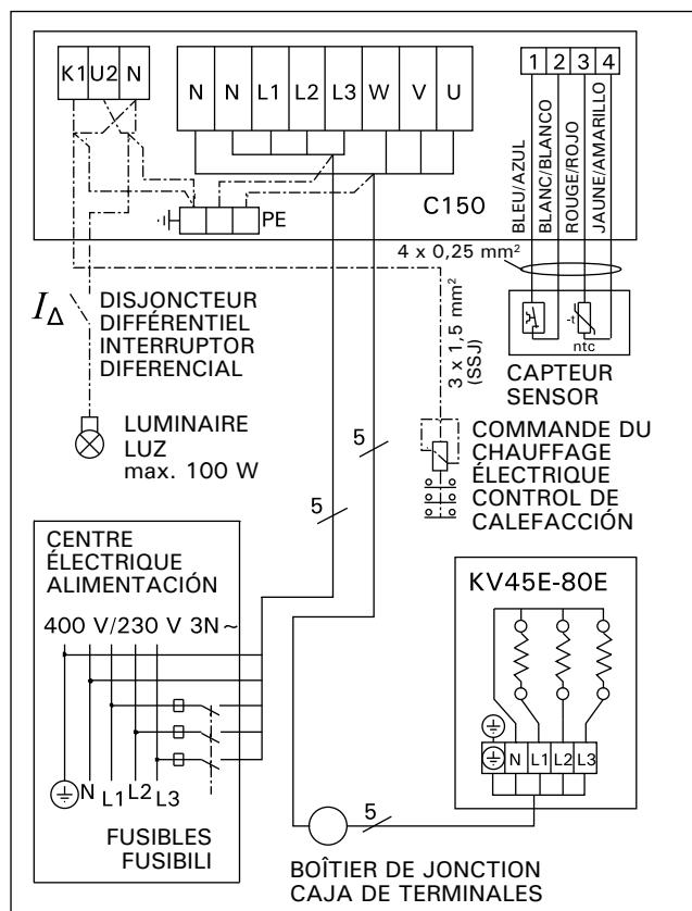
Figure 13. Raccordement électrique (centre de contrôle C150 + KV45E-80E)
