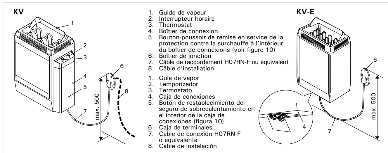
Figure 9. Pièces et connexion du poêle
