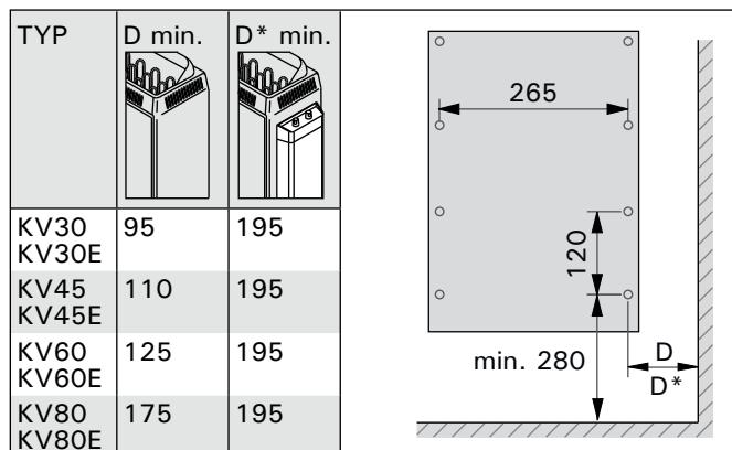
Figure 7. Fixation du poêle au mur (toutes les dimensions sont fournies en millimètres)
