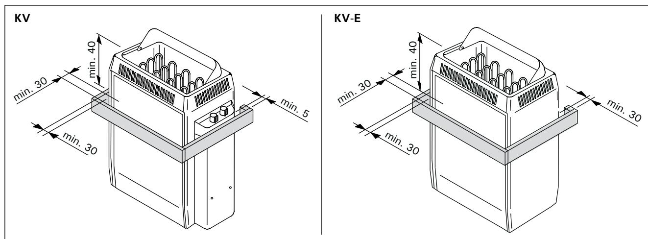
Figure 8. Rambarde de sécurité
