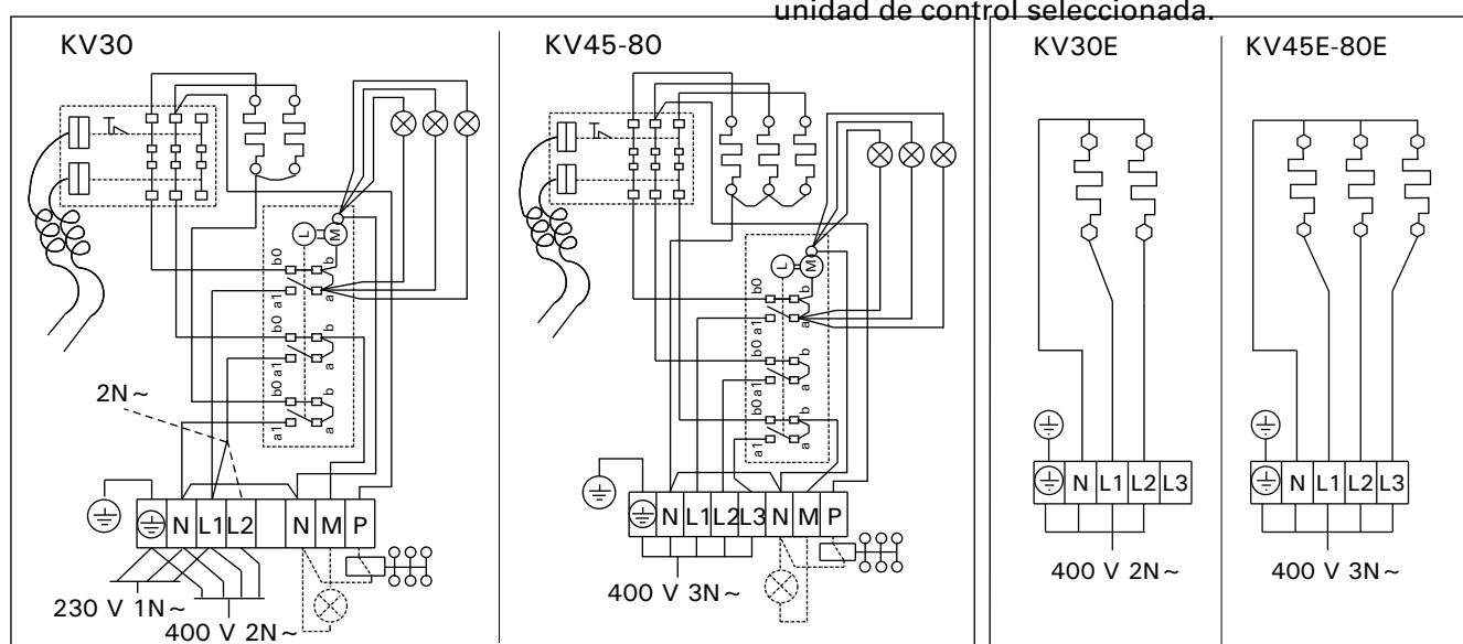
Figure 11. Raccordement électrique (KV30-80)
