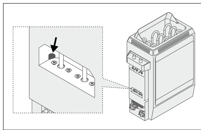
Figure 10. Bouton-poussoir de remise en service de la protection contre la surchauffe
